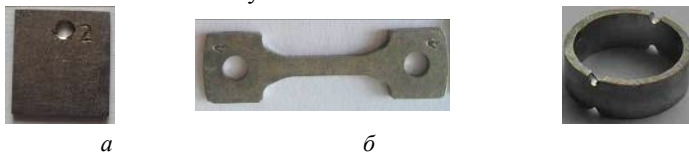
Рисунок 1 – Зовнішній вигляд зразків для металографічних досліджень (а), для випробувань на чистий згин (б) та циклічний розтяг (в)
