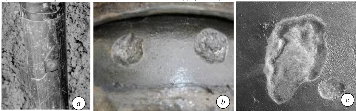
Рис. 1. Приклад корозії під дією змінного струму у Франції ( a ), у Х'юстоні ( b ) та Польщі ( c ).
