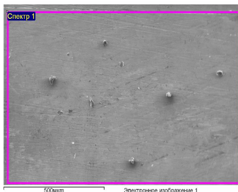
Рис. 2. Електронно-мікроскопічне зображення та мікрорентгеноспектральний аналіз поверхні сплаву Д16Т після 10 діб експозиції у кислому дощі: а) неінгібованому; б) інгібованому композицією “рамноліпідний біокомплекс (0,5 г/л)+ цинку фосфат (0,06 г/л)”.
